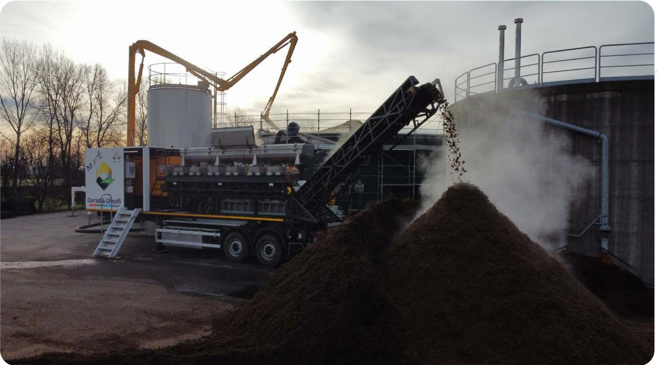
Il “Mosè” è un innovativo progetto 4.0 sviluppato da Corradi & Ghisolfi per il settore agro-zootecnico, biogas e biometano. Utilizzando il braccio Power Mix da 38 metri, consente interventi meno invasivi, economici ed energeticamente efficienti per svuotare digestori anaerobici e vasche di stoccaggio di reflui fibrosi.
