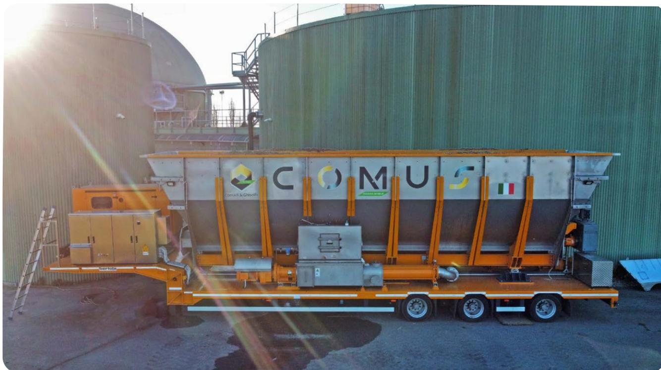
Il “**COMUS Feeding Mobile**®” è una novità del 2024 sviluppata da Corradi & Ghisolfi per i settori biogas e biometano. Progettato per sostituire temporaneamente il sistema di alimentazione della biomassa solida in impianti biogas o biometano durante guasti o manutenzioni, garantisce la continuità della produzione. Montato su semirimorchio per un facile trasporto, può essere installato rapidamente.
