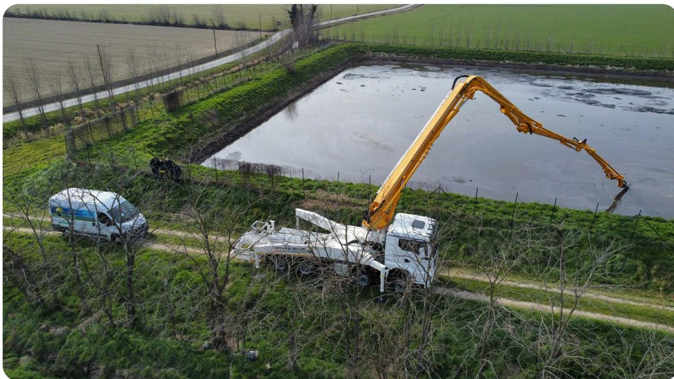
Grazie alla sua elevata capacità di aspirazione e miscelazione, il **PowerMix** è ideale per **mantenere una circolazione costante e omogenea dei reflui**, contribuendo a prevenire il deposito di materiali fibrosi e l'addensamento del contenuto.
